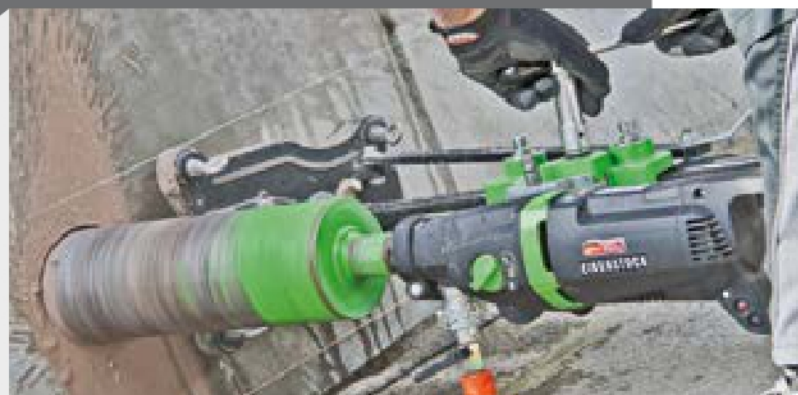
BST 182 V/S: суппорт на четырех специальных шариках
