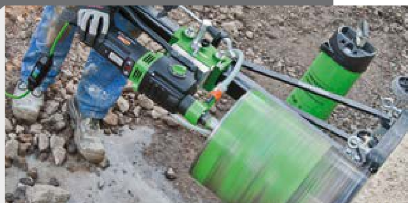
BST 352 V: auf vier Spezialkugeln gelagerter Schlitten
